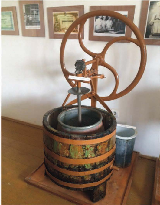
Mașina de fabricat înghețată (cu gheață de râu sau artificială)/ Prototip firma "LEOPOLD BERGER", WIEN Lichtenauergosse13.
