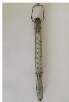
Termometru de măsurat temperatura zahărului (°C și °R)
